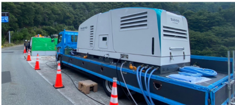
▲ スギノマシン「HI-JET 3000GT」ハイエンドな超高压ポンプユニット
